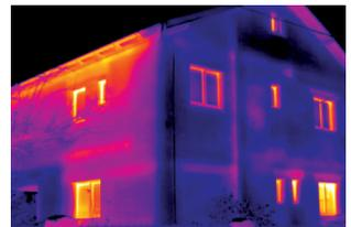
**Détecter les pertes d'énergie des bâtiments :** détecter et visualiser instantanément les ponts thermiques de façades ou à l'intérieur des bâtiments.
