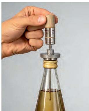
Měření teploty v konzervě/láhvi s externě namontovaným záznamníkem: testo 191-T2 + upevnění k láhvi
