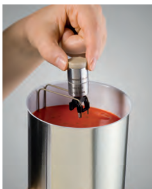
Měření teploty v konzervách: testo 191-T1 + stojánek
