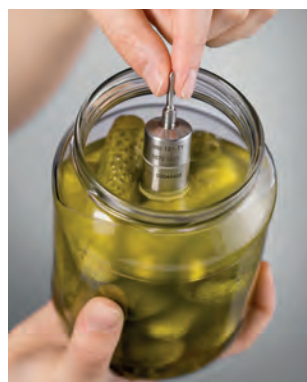
Měření teploty přímo v potravinách: testo 191-T1
