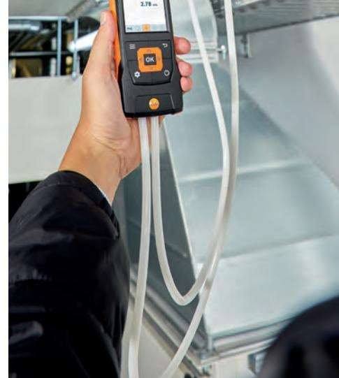
Při měření objemového průtoku při vysokých rychlostech proudění nebo v případě silně znečištěného proudění doporučujeme testo 440 dP a Pitotovu trubici.
