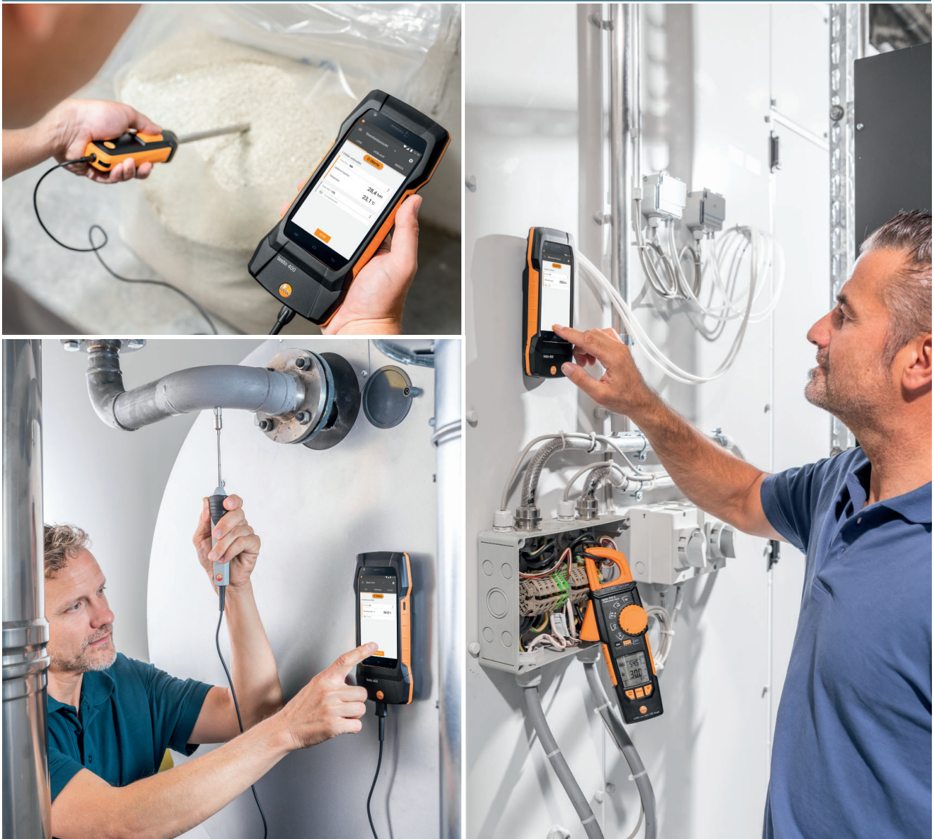
A testo 400 mérőműszerrel egyszerre akár 8 szonda is használható (4 Bluetooth-os és 4 kábeles)
