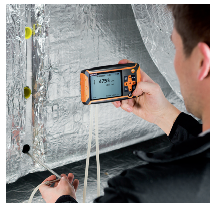
Mérés légcsatornában, Pitot csővel
