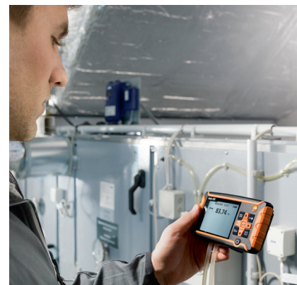
Nyomáskülönbség mérése szilikon csővel
