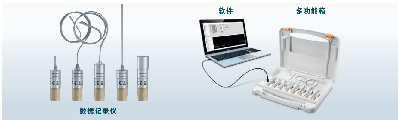
Testo 191HACCP数据记录系统可以在冻干工厂内实现高效的验证过程。这一系统包含了4个坚固、耐用、可靠的温度记录仪和一个压力记录仪；可以进行记录仪配置和数据读取的多功能箱，并且存放和安全运输记录仪；独特的testo 191专业版软件可以实现鼠标一键保存完整的跟审核相关的数据。在testo 191专业板软件开发的过程中，特别关注了操作的直观性。软件一步步引导用户进行验证过程，在关键点会有提醒信息。软件既适合专家也适用于初学者。使用专业版软件，可以配置8个记录仪控制时间和温度，并且测量结束后将多功能箱和电脑连接进行数据读取。在数据分析过程中，温度保持阶段的相关运算可以自动进行并且根据定义的公式进行再次检查。另外，软件可以快速方便地创建图片文件。最关键的一点是，不用花大量时间去整个文件，因为软件可以实现一键创建功能。
