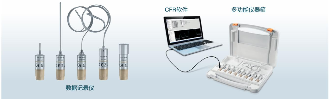
testo 190 CFR数据记录仪系统可以实现对冻干设备的高效验证。该系统有四种类型的温度记录仪和一个压力记录仪组成，坚固、耐用、可靠。**多功能仪器箱**用于记录仪的编程、读取以及存储和安全运输；独特的**testo 190 CFR软件**，点击鼠标按钮即可获取完整的审计相关文件。
