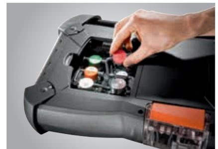
testo 350 内置德国原装强力气体采样泵，特别适用于存在负压的环境下采样，抗负载能力大于30 kPa。
