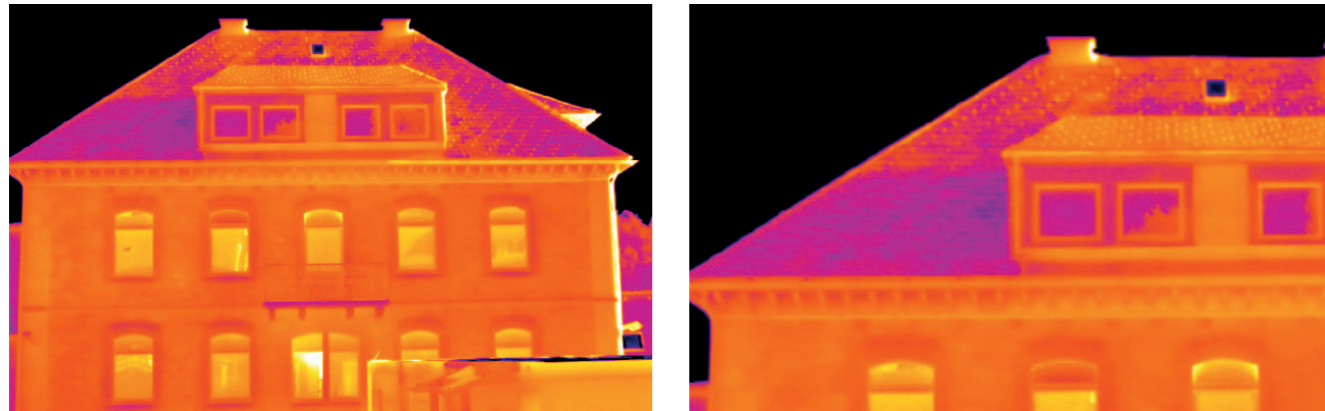
Aufnahme eines Gebäudes mit einem 42°- (links) und einem 25°-Weitwinkelobjektiv (rechts). Wie Sie sehen, sehen Sie mehr.
