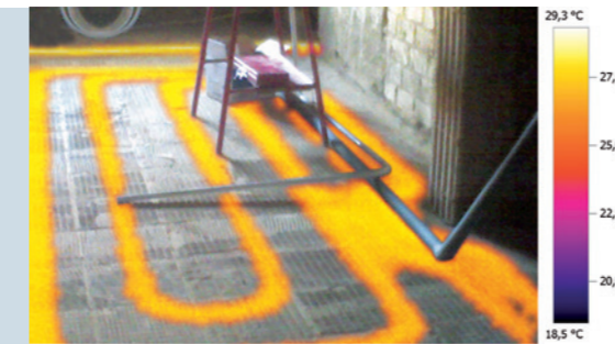
Verdeckte Rohrleitungen mit TwinPix auch im Echtbild erkennen
