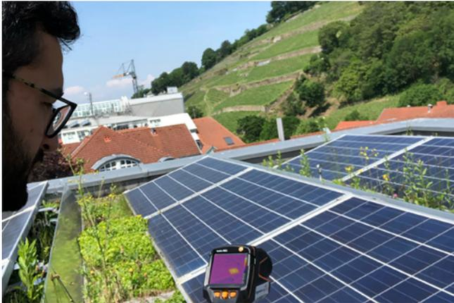
Figure 3 : Utilisation de la caméra thermique testo 883 pour le contrôle d'une installation photovoltaïque.
