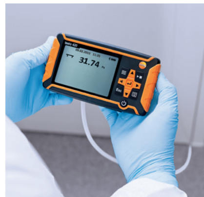
Mesure de la pression différentielle avec tuyau de raccordement
