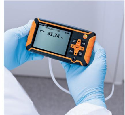
Differenzdruckmessung mit Anschlusschlauch
