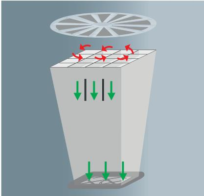
Funktionsprinzip des Strömungsgleichrichters
