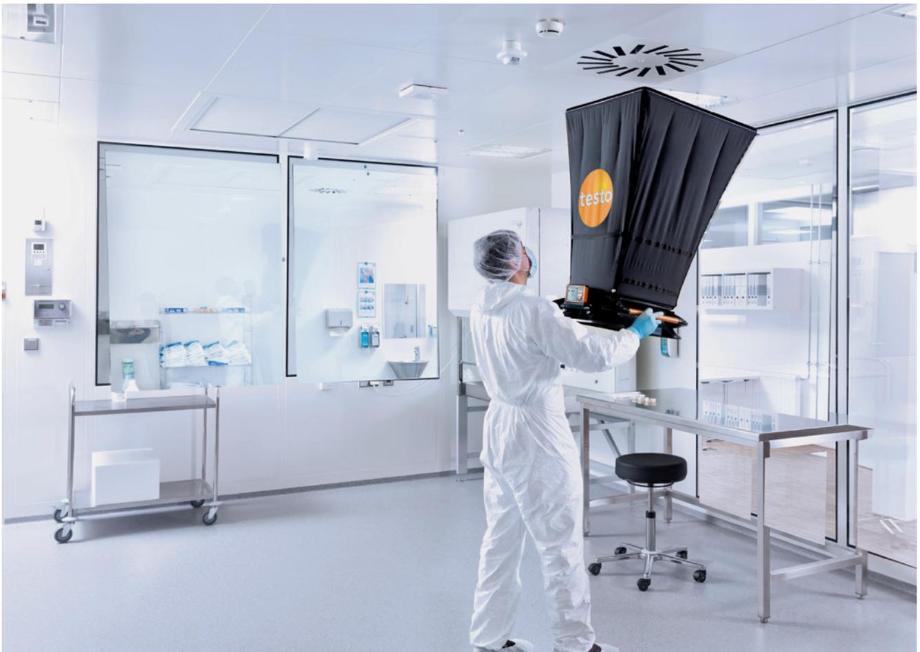
RLT-Anlagen in Reinräumen müssen hohe gesetzliche Hygienestandards erfüllen. Damit die unterschiedlichen Normen und Richtlinien für diese Standards eingehalten werden, muss die vorgeschriebene Luftwechselrate des Raumes durch Überprüfen des Gesamtvolumenstroms der Anlage regelmäßig sichergestellt werden. Diese Überprüfung erfolgt oft an größeren Drallauslässen, welche die Luft gleichmäßig verteilen. Das Problem an den Drallauslässen: durch die verwirbelte Luft kann das Messergebnis stark
