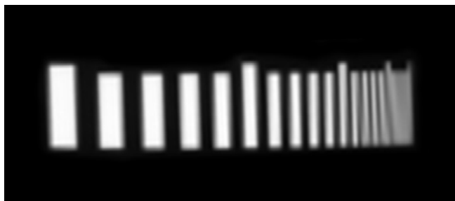
Abb. 2: Aufnahme ohne testo SuperResolution-Technologie
