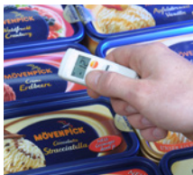
Infrarot-Messung in der Tiefkühltruhe
