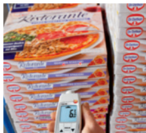
Infrarot-Messung im Wareneingang
