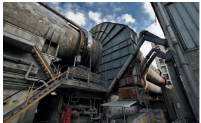
在预热设备和回转窑中烧制原料颗粒
