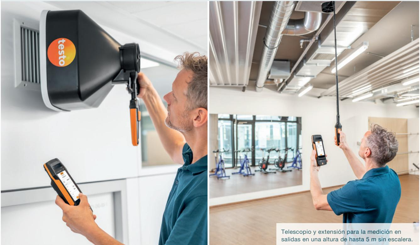
Telescopio y extensión para la medición en salidas en una altura de hasta 5 m sin escalera.
