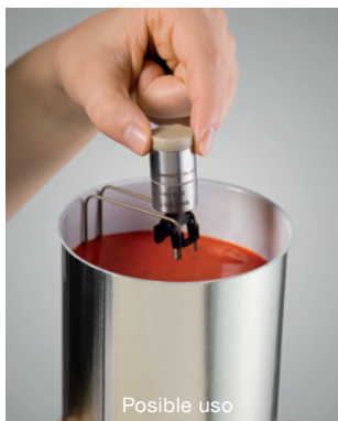
Medición de la temperatura en una lata: testo 191-T1 + Trípode
