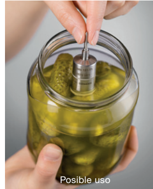
Medición de la temperatura directamente en el alimento: testo 191-T1
