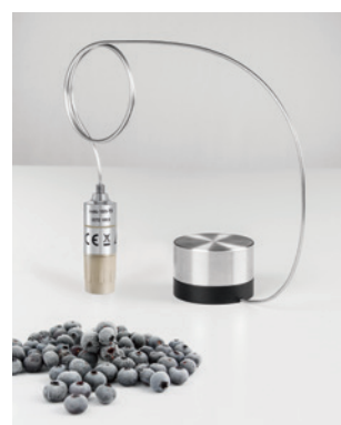
Medición de la temperatura durante la liofilización: testo 191-T3/-T4 + Soporte de sondas para liofilización
