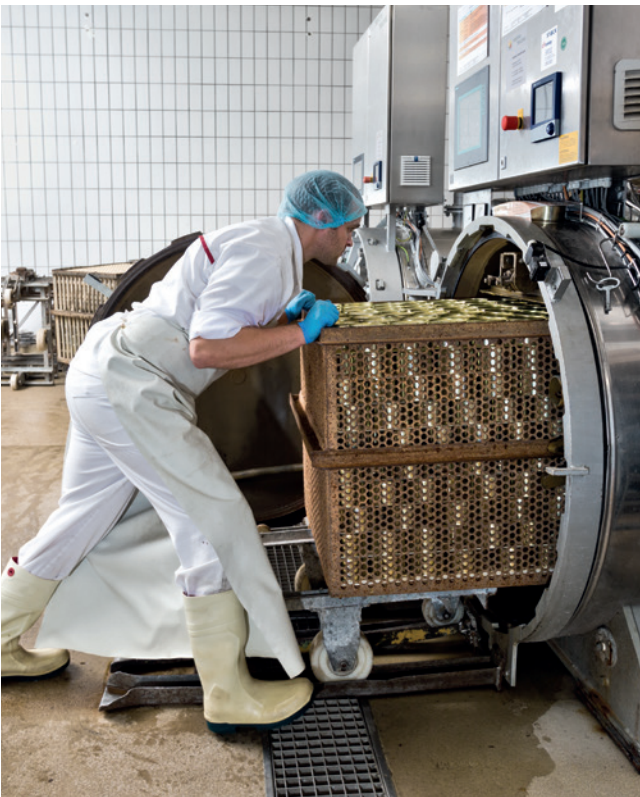
Autoklavierung von Wurstkonserven.
