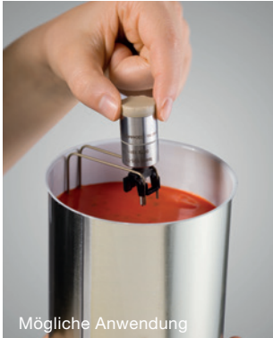
Temperaturmessung in einer Dose: testo 191-T1 + Stativ
