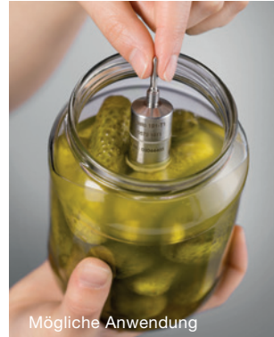
Temperaturmessung direkt im Lebensmittel: testo 191-T1
