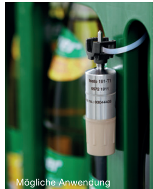
Temperaturmessung in einer Dose/Flasche mit externer Anbringung des Loggers: testo 191-T2 + Dosen- und Flaschenbefestigung
