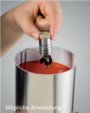
Temperaturmessung in einer Dose: testo 191-T1 + Stativ
