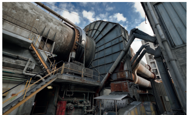
Brennen des Rohmehls in der Vorwärmanlage und im Drehrohrföfen.
