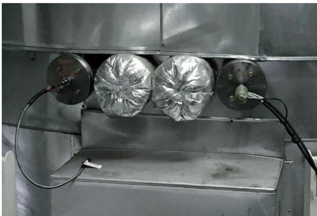
La sonde du testo 350 fixée au point de mesure à l'aide d'une bride.
