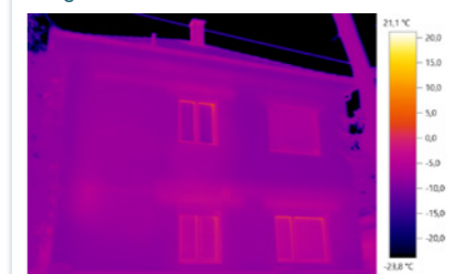
Skala ist zu hoch eingestellt: scheinbar keine Sanierungsmaßnahmen nötig.
