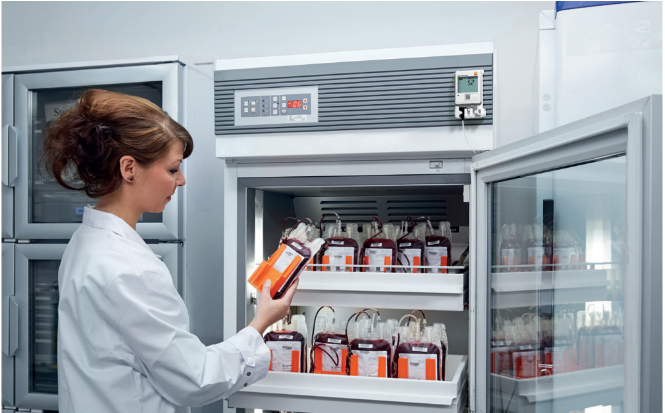
Een draadloze datalogger bewaakt de temperatuur in de bloedkoelkast en alarmeert het personeel wanneer kritische afwijkingen optreden.
