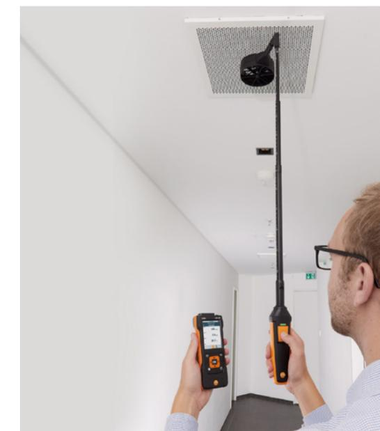
La sonde à hélice de 100 mm peut être confortablement fixée à un coude à 90° qui, associé à un télescope, simplifie les mesures sur les diffuseurs de plafond.
