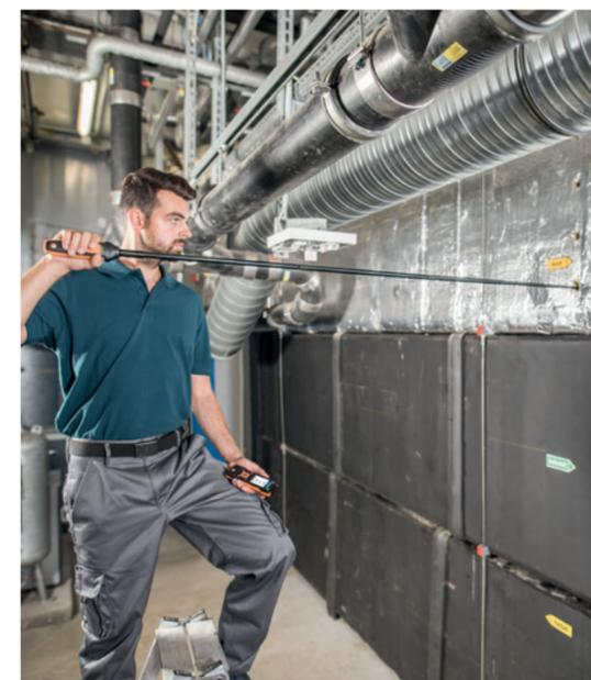
Toutes les sondes d'écoulement testo 440 destinées aux mesures dans les canalisations d'air sont dotées d'un télescope extensible gradué (pouvant être rallongé de 1 à 2 m, en option).
