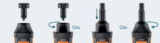
Il suffit de quelques secondes pour fixer une poignée testo 440 simplement et en toute sécurité directement sur une tête de sonde ou sur un adaptateur pour télescope et têtes de sonde.
