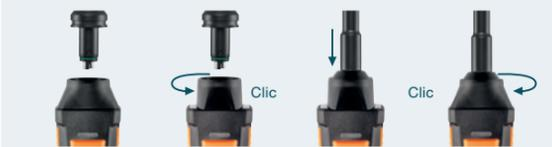
Una empuñadura testo 440 puede conectarse fácilmente en segundos y de forma segura directamente con un cabezal de la sonda o con un adaptador para el brazo telescópico y los cabezales de la sonda.
