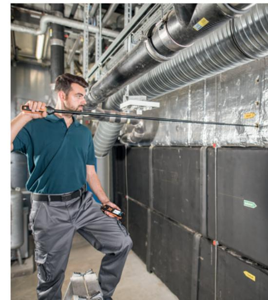
Todas las sondas de velocidad testo 440 para mediciones en canales tienen un brazo telescópico con escala y extensible (con opción de extensión entre 1 y 2 m).
