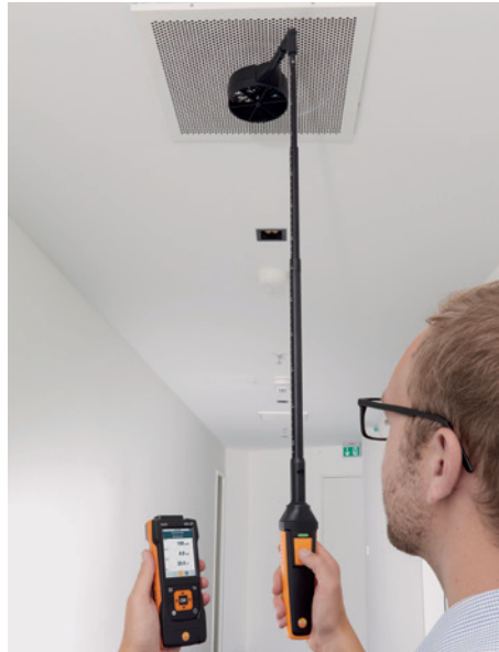
La sonda de molinete de 100 mm puede conectarse cómodamente con el ángulo de 90° y el brazo telescópico. Esto simplifica las mediciones en las salidas de techo.
