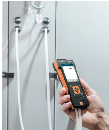
Con el modelo testo 440 dP incl. sensor de presión diferencial se asegura que los filtros de las instalaciones de climatización funcionen correctamente y que no penetren impurezas al aire ambiente provenientes del aire exterior.
