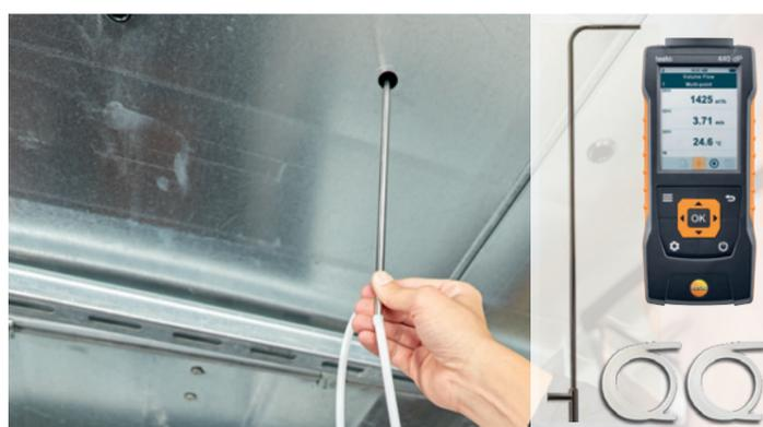
Klima-Messgerät inkl. Differenzdruck testo 440 dP (0563 4402) plus:
