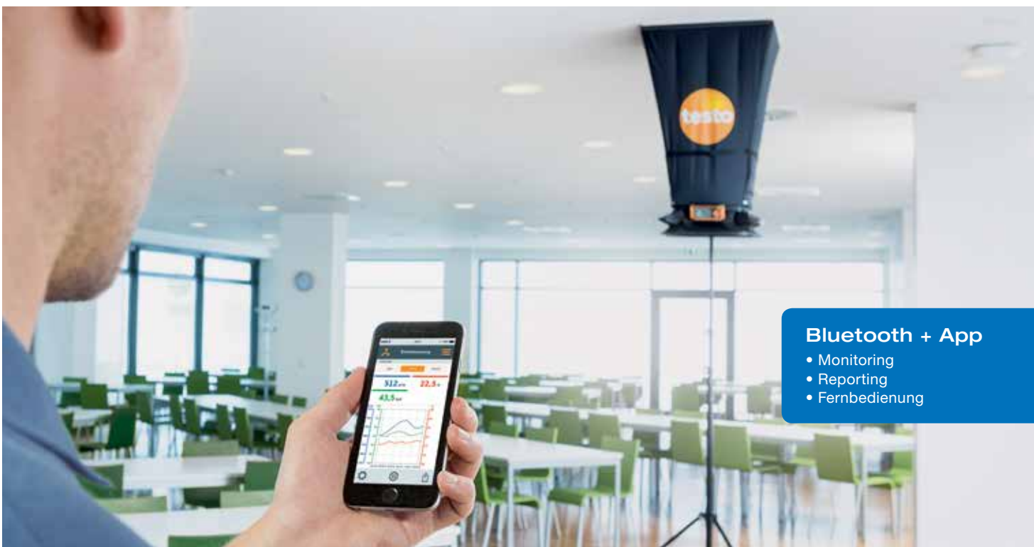
Ohne Strömungs-Gleichrichter kann das Messergebnis durch Luftverwirbelungen verfälscht werden.
