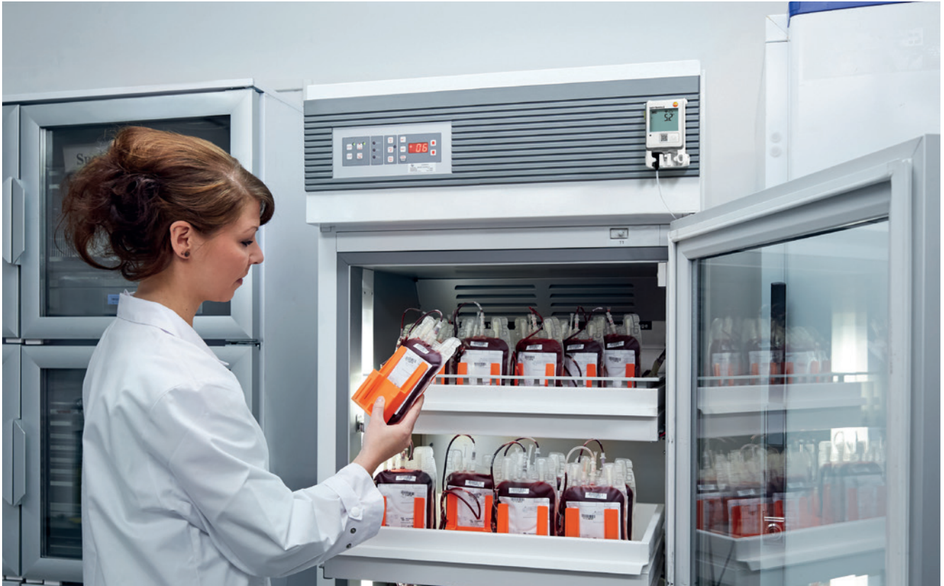
Ein Funk-Datenlogger überwacht die Temperatur im Blutkühlschrank und alarmiert das Personal, wenn es zu kritischen Abweichungen kommt.
