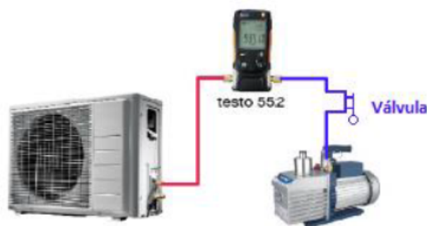
Figura 3 - Ejemplo de conexionado de sistema, bomba, vacuómetro y válvula
