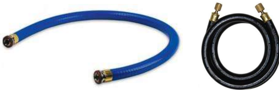
Figura 1- La utilización de mangueras adecuadas, de mayor sección, menor longitud y barrera impermeable es fundamental para poder alcanzar buenos niveles de vacío.
