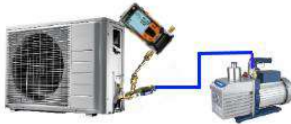
Figura 4– Una mejor opción: reemplazo de la manguera por una válvula de grado vacío y un acople para vacuómetro.
