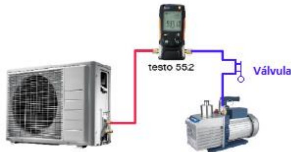
Figura 1 - Ejemplo de conexionado de sistema, bomba, vacuómetro y válvula
