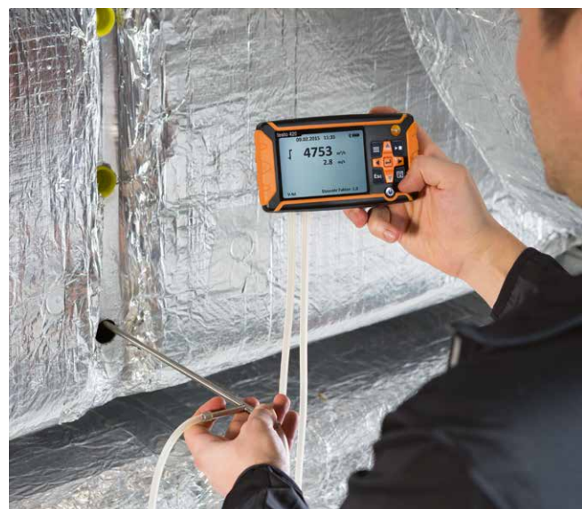
Abnehmbares Gerät ermöglicht Staurohrmessungen im Kanal (Staurohr separat erhältlich)
