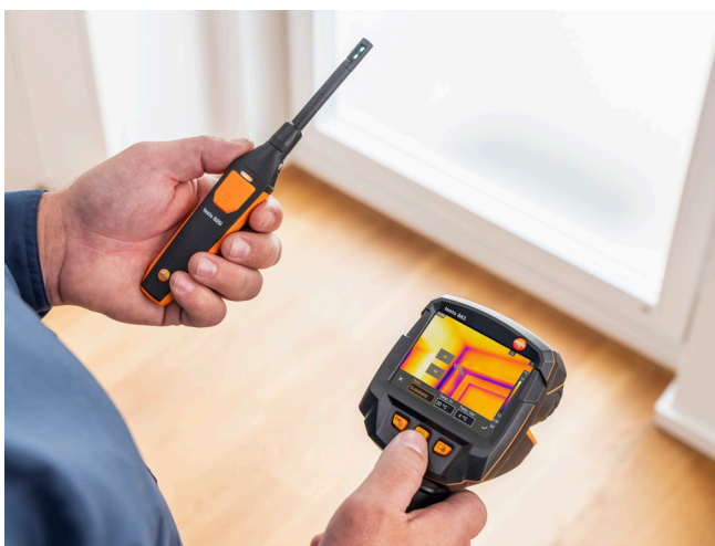
Wärmebildkamera testo 883 mit Thermo-Hygrometer testo 605i bei der Schimmelindikation.
