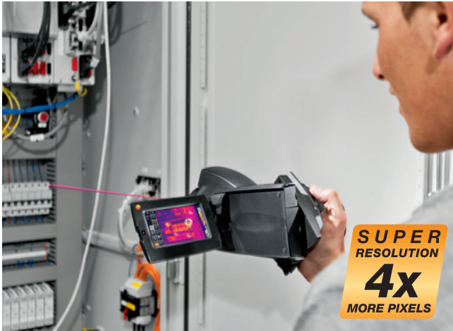
Para la termografía digital son imprescindibles imágenes térmicas de alta resolución
