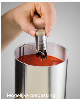
Temperatuurmeting in een blik: testo 191-T1 + statief
