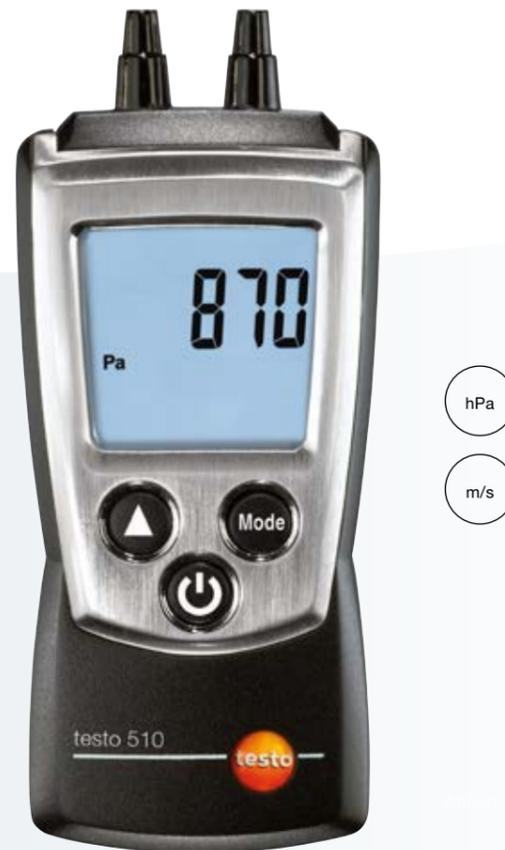
testo 510 misst den Differenzdruck im Bereich von 0...100 hPa. Für genaue Messwerte ist die Differenzdruckmessung temperaturkompensiert. Die Messwerte können über den gesamten Messbereich in Pascal angezeigt werden. Magnete an der Geräterückseite erlauben freihändiges Arbeiten.
