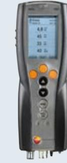
Das testo 340 muss mit einem zweiten Gas-Sensor bestückt werden, sonst ist das Gerät nicht funktionsfähig. Es können max. 3 zusätzliche Sensoren bestückt werden.
