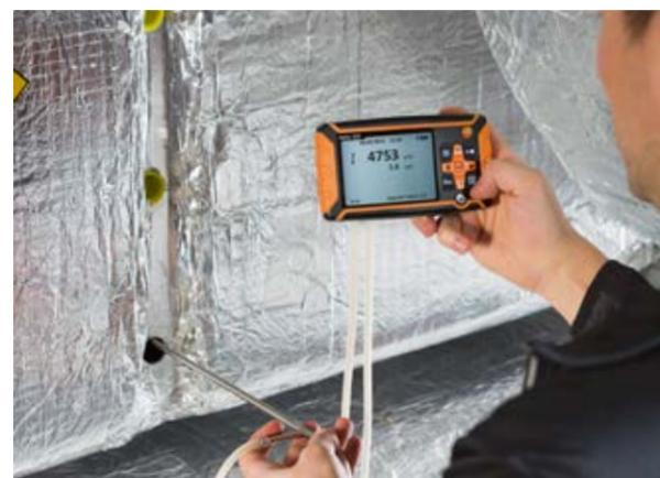
Abnehmbares Gerät ermöglicht Staurohrmessungen im Kanal (Staurohr separat erhältlich)
