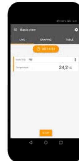
**Mit der kostenlosen testo Smart App wird Ihr Smartphone zum Display des testo 915i.** Sowohl die Bedienung der Smart Probe als auch die Anzeige der Messwerte erfolgen kabellos per Bluetooth® auf Ihrem Smartphone – unabhängig vom Messort. Zudem können Sie in der App Messprotokolle erstellen, diese mit Fotos und Kommentaren versehen und bequem per E-Mail versenden.
