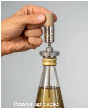
Medição de temperatura em uma lata/garrafa com o logger instalado externamente:
