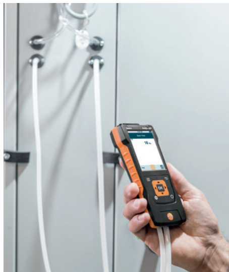
Met het model testo 440 dP incl. verschildruksensor zorgt u ervoor dat de filters van airconditioners correct functioneren en dat er geen vuil uit de buitenlucht in de omgevingslucht terecht komt.
