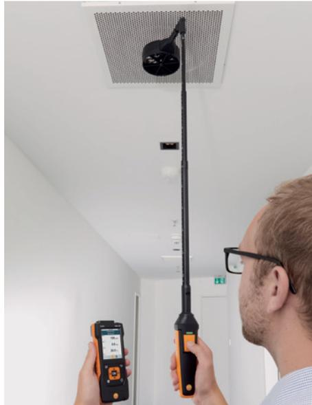
La sonde à hélice de 100 mm peut être confortablement fixée à un coude à 90° qui, associé à un télescope, simplifie les mesures sur les diffuseurs de plafond.
