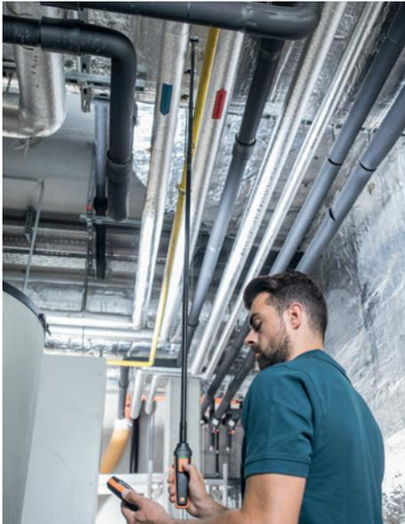
Toutes les sondes d'écoulement testo 440 destinées aux mesures dans les canalisations d'air sont dotées d'un télescope extensible gradué (pouvant être rallongé de 1 à 2 m, en option).
