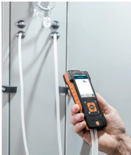
Avec le modèle testo 440 dP et son capteur de pression différentielle, vous pouvez être assuré que tous les filtres de vos installations de climatisation fonctionnent correctement et qu'aucune saleté extérieure ne pénétrera dans l'air ambiant.
