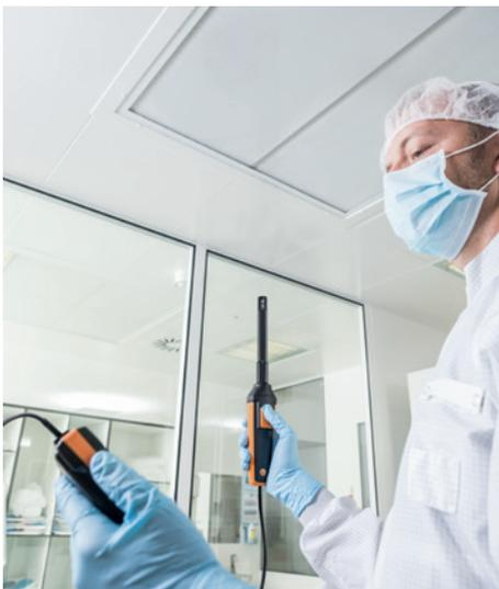
Vous devez également procéder à des mesures dans des environnements dans lesquels aucune liaison Bluetooth n'est possible ? Aucun problème ! Il suffit d'enficher la tête de sonde sur la poignée câblée et c'est reparti.
