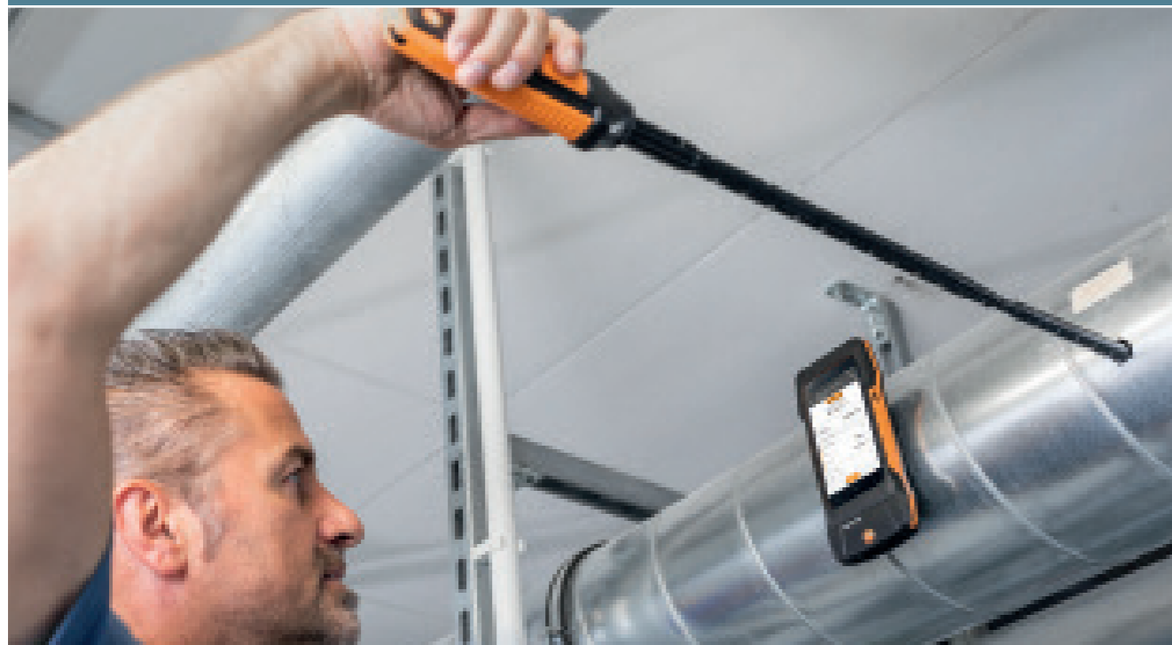
Fixer tout simplement la face arrière du testo 400 sur la canalisation et réaliser la mesure aisément avec la touche de mesure disposée sur la poignée de sonde.
