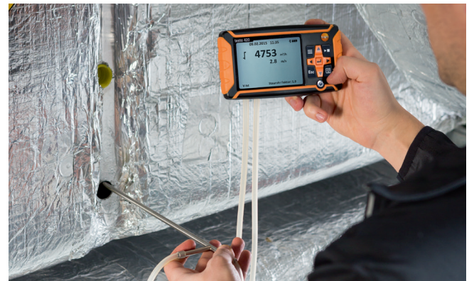
Kanallarda pitot tüp ölçümüne olanak tanıyan sökülebilir cihaz (Pitot tüp, ayrı olarak mevcuttur)
