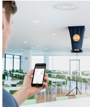
Ölçüm verilerinin mobil cihazlarda görüntülenmesi ve ölçüm raporunun sahada sonlandırılması için Bluetooth üzerinden uygulama entegrasyonu.
