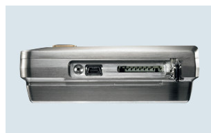
Conexiune laterală pentru cablu mini USB și card SD
