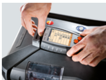
Jednostka sterująca jest montowana przez „kliknięcie”
