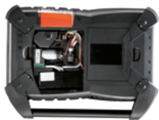
Pokrywa serwisowa zapewnia łatwy dostęp do zużywających się części
