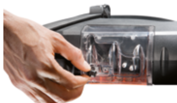
Stałe odsączanie kondensatu podczas pomiarów długotrwałych
