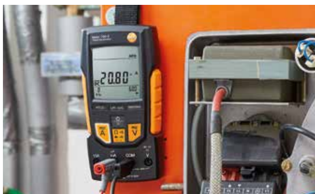
Poprzez automatyczne wykrycie parametru pomiarowego multimeter testo 760-2 zapewnia wyeliminowanie nieprawidłowych ustawień.
