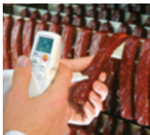
Pomiar pH w dojrzewającej, surowej kielbasie
