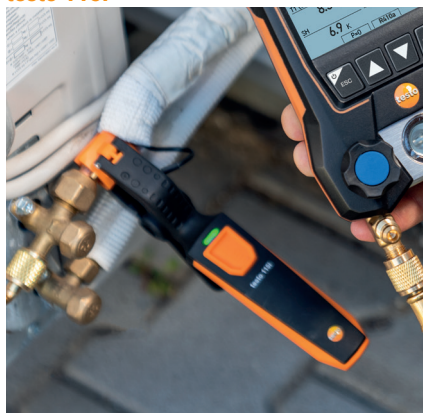
Termometr zaciskowy testo 115i
