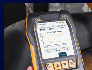
Elektroniczna oprawa zaworowa
