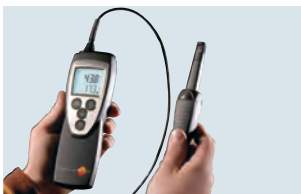
Vochtvoelerkop op de handgreep met voelerleiding, bijvoorbeeld voor het controleren van het opslagklimaat
